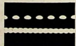
Abb. 5. Vergrößerte Strahlspuren mit Hell-Dunkel-Steuerung und helligkeitsmodulierte Spur mit dicht nebeneinanderliegenden Modulationsmarken
