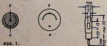
Abb. 1. Sockelschaltbild und Abmessungen der Fotozellen 3545 und 3546
