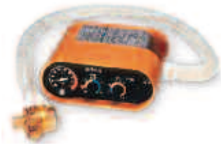
Beatmungsgerät Oxylog in seiner ersten Ausführung. Volumenkonstante Beatmung in der Notfallmedizin
