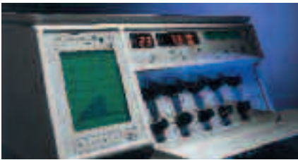
Überwachungseinrichtungen einer Evita 2. Die numerischen Werte neben dem Grafikbildschirm sind nach Priorität geordnet
