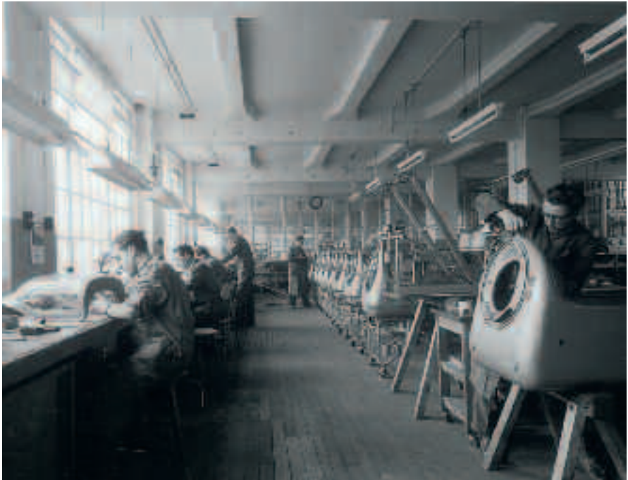
Serienfertigung der Eisernen Lunge im Drägerwerk
