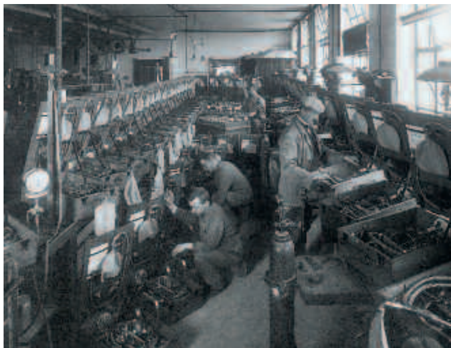
Serienfertigung des Pulmotors
