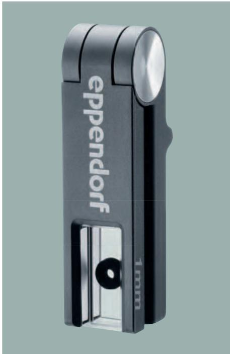
Die  $\mu$ Cuvette G1.0 bietet mit einer optischen Schichtdicke von nur 1 mm einen 10fach kürzeren Lichtweg als Standardküvetten. Somit können mit Hilfe der  $\mu$ Cuvette G1.0 hohe Nukleinsäure- und Proteinkonzentrationen gemessen werden. Dabei benötigt man gerade einmal 1,5  $\mu$ L seiner Probe für die Messung. Die  $\mu$ Cuvette G 1.0 erweitert flexibel den photometrischen Anwendungsbereich der Eppendorf Photometer.
