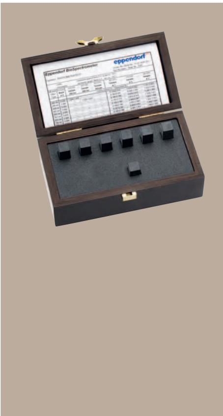
Der sekundäre UV/Vis-Referenzfiltersatz dient zur Überprüfung der photometrischen Richtigkeit und der Wellenlängenrichtigkeit gemäß NIST (National Institute of Standards and Technology, Gaithersburg MD, USA).
